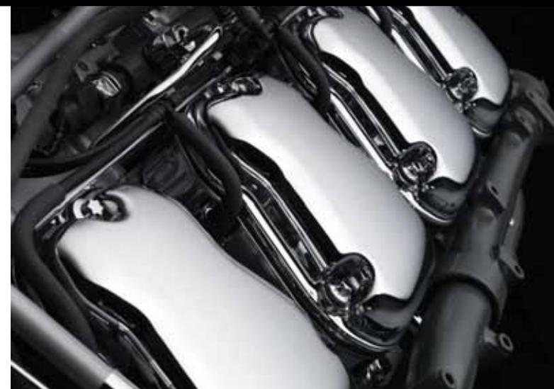
Автомобили серии Scania Griffin комплектуются рядными 6-цилиндровыми 4-тактными дизельными двигателями непосредственного впрыска с турбонаддувом и промежуточным охлаждением воздуха.
