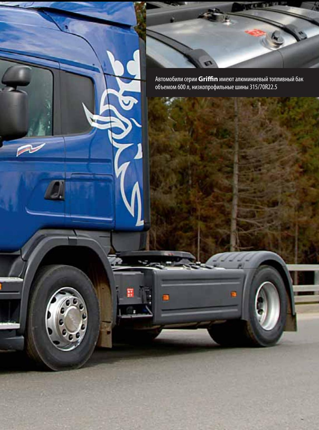
Автомобили серии **Griffin** имеют алюминиевый топливный бак объемом 600 л, низкопрофильные шины 315/70R22.5
